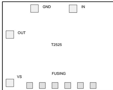
Figure 12. Pad Layout 2 (DDW, SO8 or TSSOP8)
