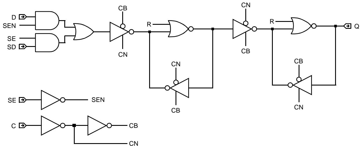
**AMI500MXSC 0.5 micron CMOS Standard Cell**
