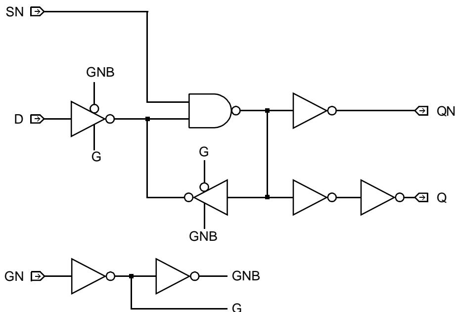
**AMI500MXSC 0.5 micron CMOS Standard Cell**
