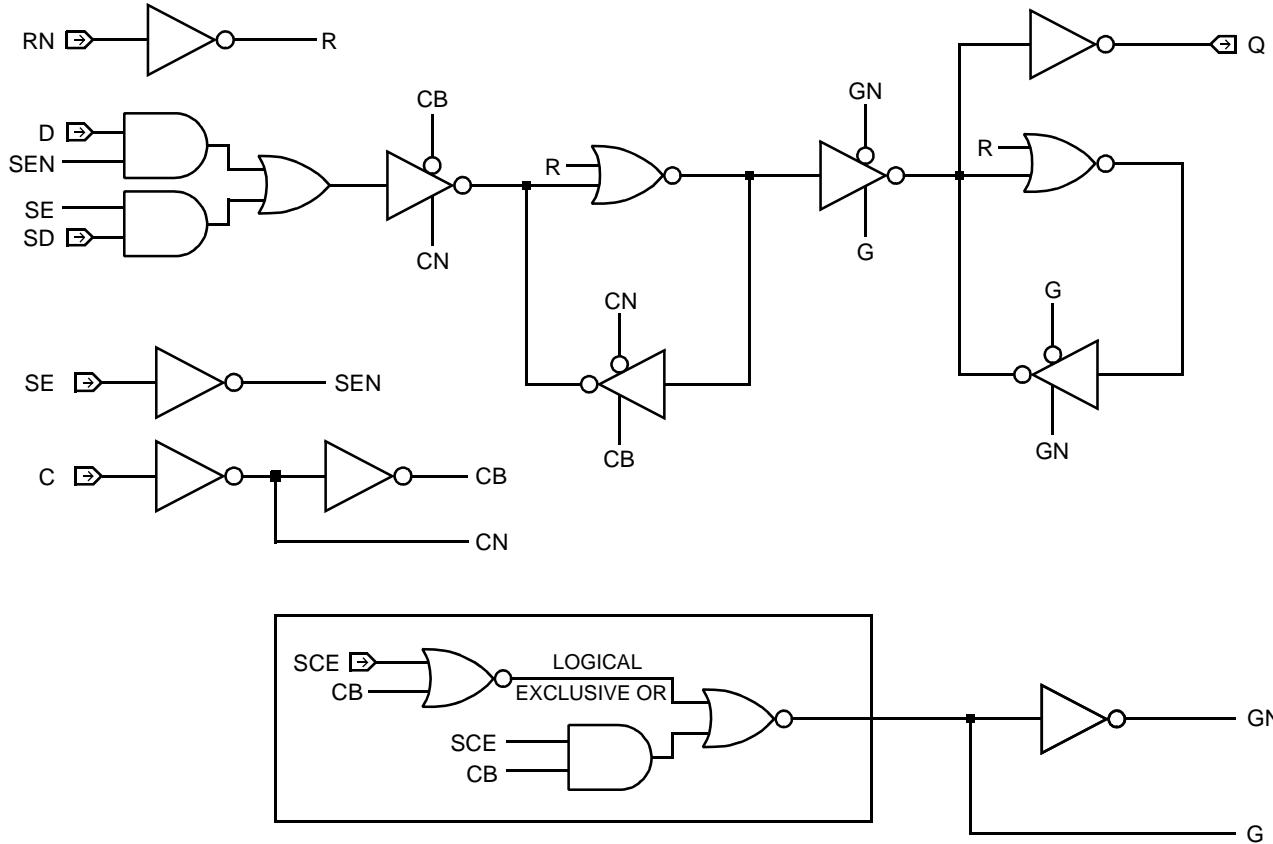
**AMI500MXSC 0.5 micron CMOS Standard Cell**
