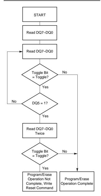
**Note:** The system should recheck the toggle bit even if DQ5 = "1" because the toggle bit may stop toggling as DQ5 changes to "1." See the subsections on DQ6 and DQ2 for more information.
